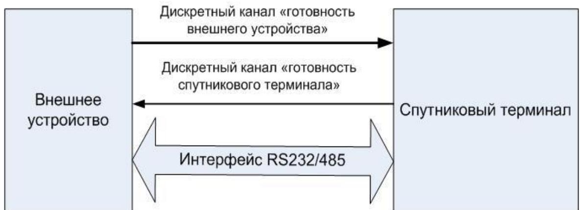
Рисунок 3 - Схема взаимодействия внешнего устройства и спутникового терминала
